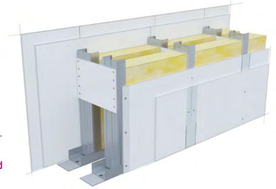
**SWE14** Wandhöhen zweilagig beplankter Doppelständerwände mit kraftschlüssig verbundenen CW-Profilen mit Easyboard
