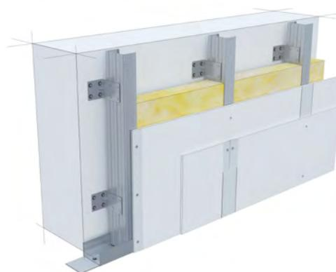
**SWE44** Wandhöhen rückverankerter Vorsatzschalen mit Easyboard und CW-Profilen
