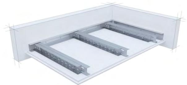
**SDE59** Spannweiten mit Doppel-UA-Profilen als Weitspannträger
