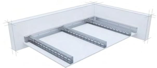
**SDE59** Spannweiten mit einfachen UA-Profilen als Weitspannträger
