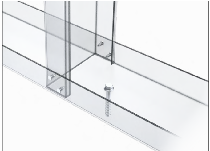
Abb. 1: Diagonale Verschraubung Bodenanschluss
