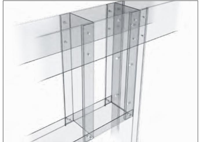
**Abb. 1:** Oberer Anschluss an Ringankerprofile
