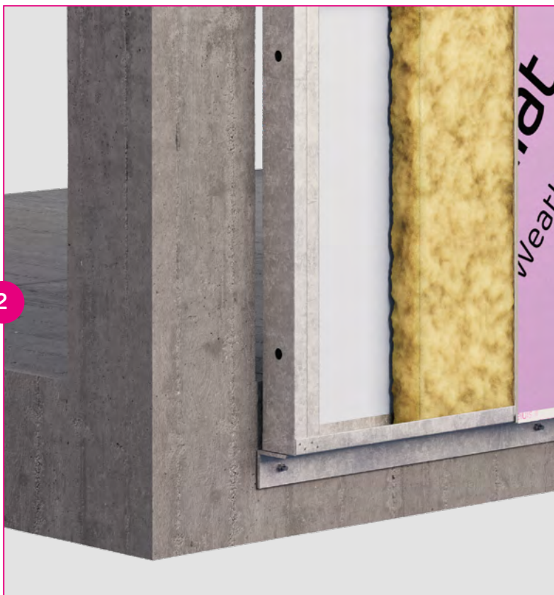
Vorgesetzte Variante - montiert auf Stahlwinkelprofil – Zugewinn an Nutzfläche
