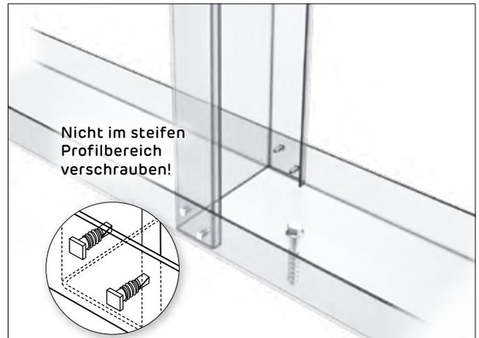
Abb. 5: Bodenanschluss
