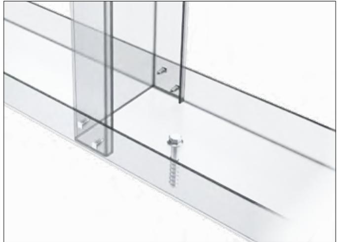
Abb. 1: Diagonale Verschraubung Bodenanschluss
