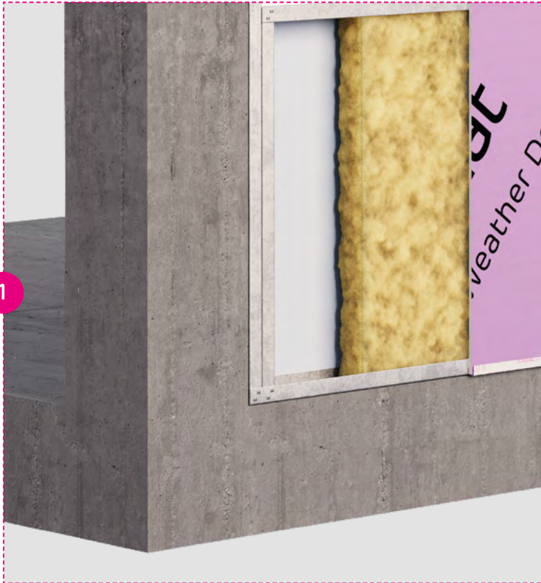
Eingesetzte Variante - montiert im Bestandsgebäude – ermöglicht bündige Ausführung
