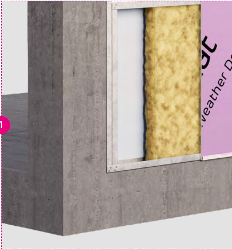
Eingesetzte Variante - montiert im Bestandsgebäude – ermöglicht bündige Ausführung
