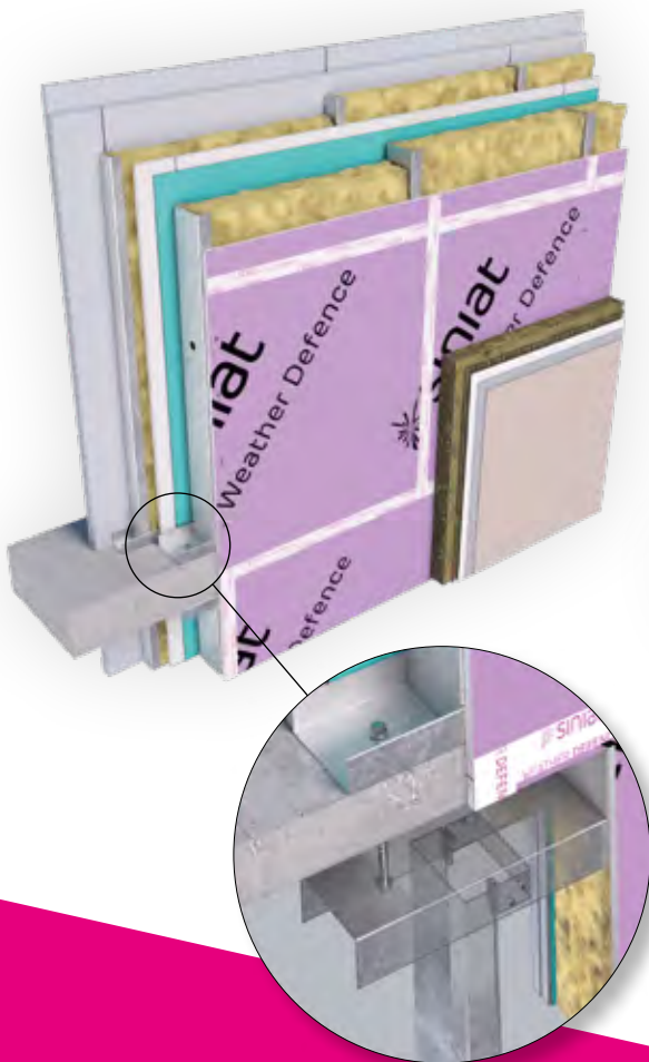
Abb. 1: eingestellte Infill Wall mit innenliegender Vorsatzschale
