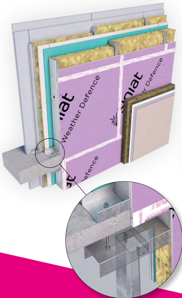
Abb. 1: eingestellte Infill Wall mit innenliegender Vorsatzschale
