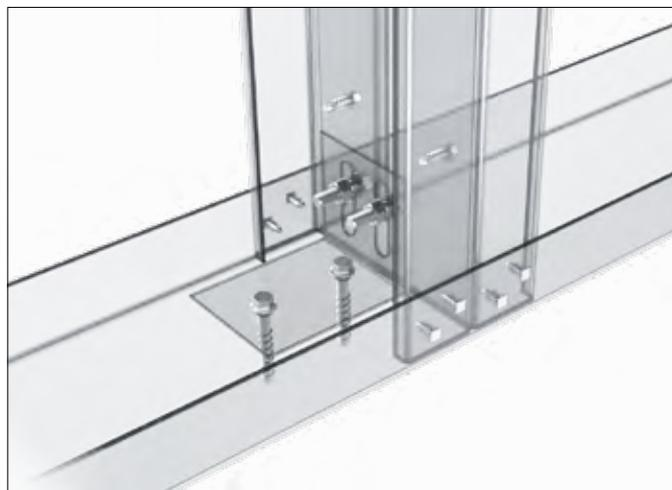
**Abb. 1:** Bodenanschluss mit Verstärkung durch Montagewinkel bei Öffnungen wie Fenster oder Türen
