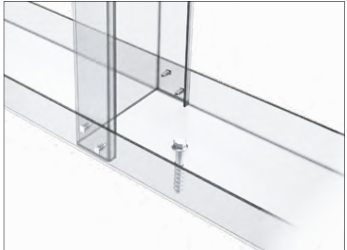
Abb. 1: Diagonale Verschraubung Bodenanschluss
