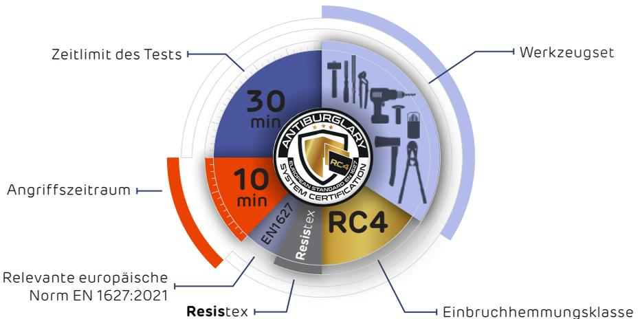
**Zeitlimit des Tests** Die maximale Gesamteinbruchversuchszeit ist die Summe aus Zeitpunkt der Einschläge, Ruhezeit, Werkzeugwechselzeit und Beobachtungszeit.
