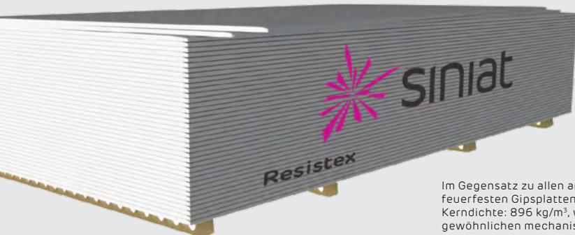
Im Gegensatz zu allen anderen Standard- oder feuerfesten Gipsplatten hat **Resistex** eine höhere Kerndichte: 896 kg/m<sup>3</sup>, welche zu den außergewöhnlichen mechanischen Eigenschaften des Produkts führt. Ein hoher Anteil an Glasfasern im Inneren des Kerns sorgt für eine gleichmäßige, hohe Dichte, die eine leistungsfähige Anwendung der üblichen Trockenbauweise ermöglicht.
