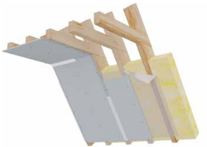
SD62 – Stropna obloga izravno pričvršćena bez potkonstrukcije
