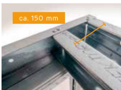
Die Weitspannträger müssen mind. 30 mm auf dem Flansch der U-Profile aufliegen. Die Montage der Raumsystem-Weitspannträgerprofile wird je nach statischen Anforderungen als Einfach- oder als Doppel-Weitspannträger ausgeführt.
