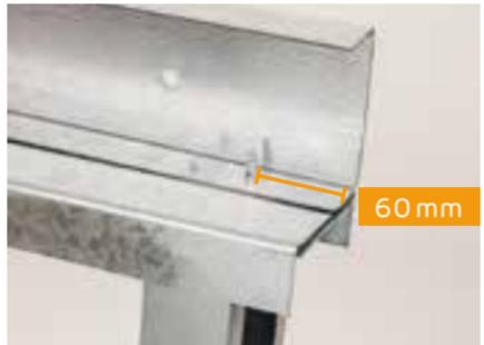
Das Raumsystem U-Profil ist außenbündig mit dem Decken-SR-Verbinder zu verschrauben. Die Verschraubung erfolgt mit einer Blechschraube von unten durch den SR-Verbinder (SuperTEKS 6,3 x 19 mm).
