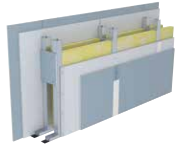
SW14 DA MD04 – Gleitender Deckenanschluss an Massivdecke
