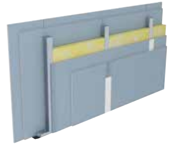
SW12 EA02 – Rechtwinklige Eckausbildung mit CW-Profilen; Horizontalschnitt
