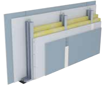
SW13 WA TW02 – T-Stoß mit CW-Profilen und unterbrochener Beplankung
