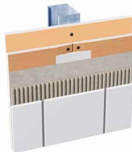
Typischer LaHydro-Wandaufbau mit Flächenabdichtung, Fliesenkleber und Fliesen.
