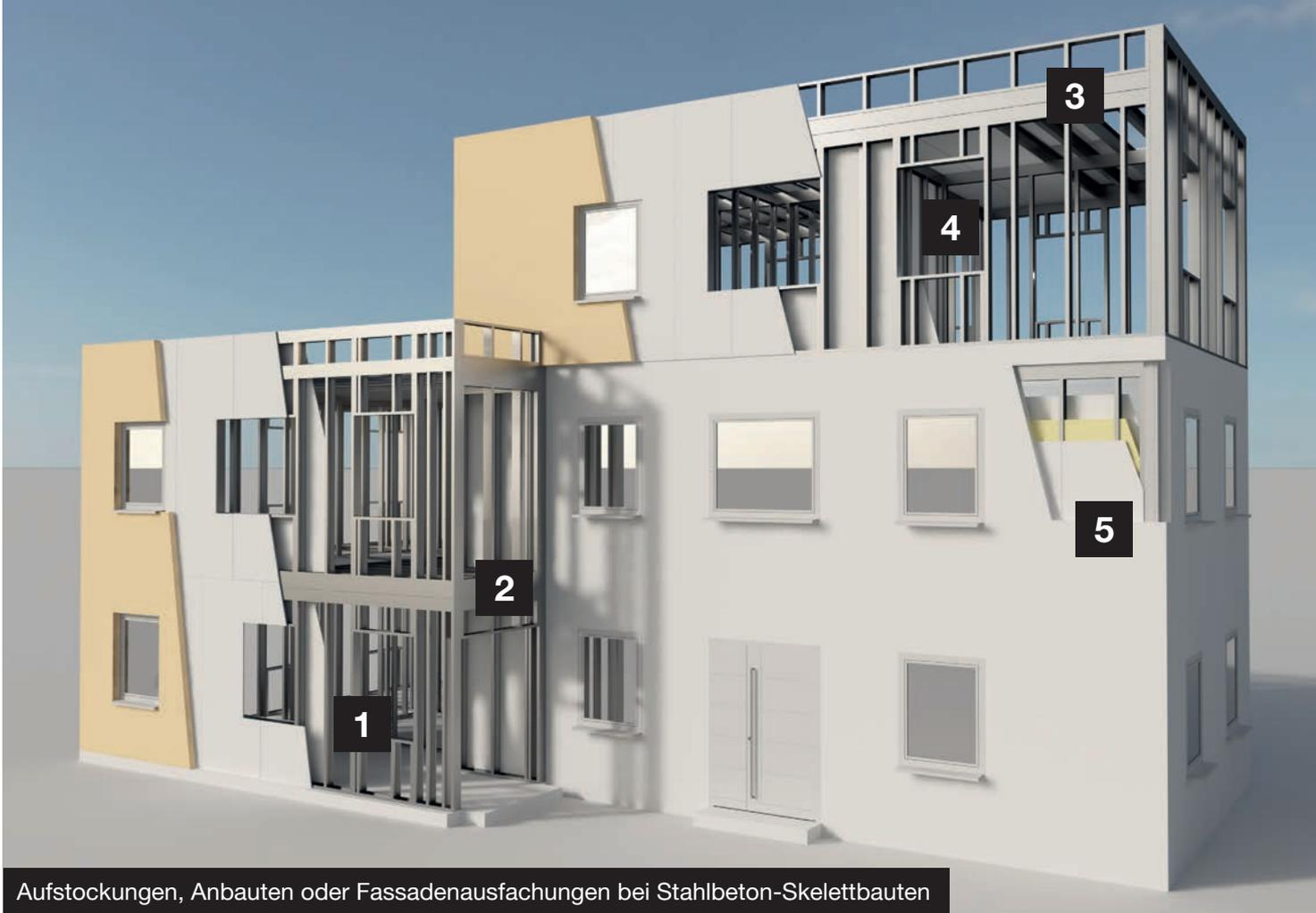
Aufstockungen, Anbauten oder Fassadenausfachungen bei Stahlbeton-Skelettbauten
