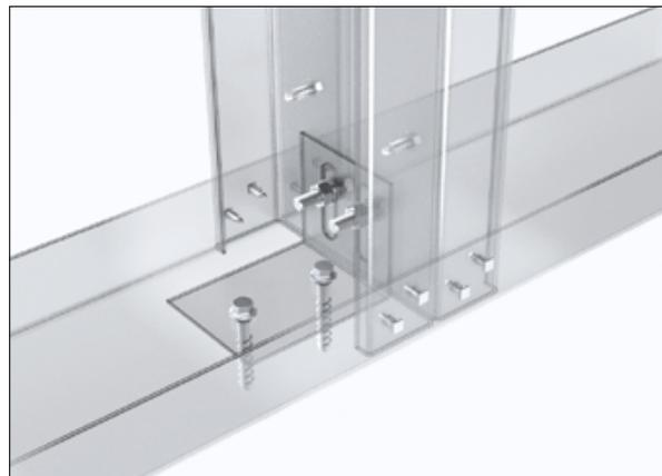
Bodenanschluss mit Verstärkung für Öffnung
