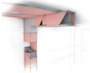
Stahlstützen- & Stahlträgerbeklei- dungen 3-seitig/Brandschutz bis 180 Minuten Feuerwiderstand
